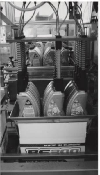
α) έξι εμφιαλωτικές και ηλεκτρονικά ολεγχόμενες γραμμές παραγωγής για συσκευασίες από 250ml έως 1000L IBCs. Με μέγιστη ταχύτητα παραγωγής 3.000 φιαλών 1L σε 1ώρα.
